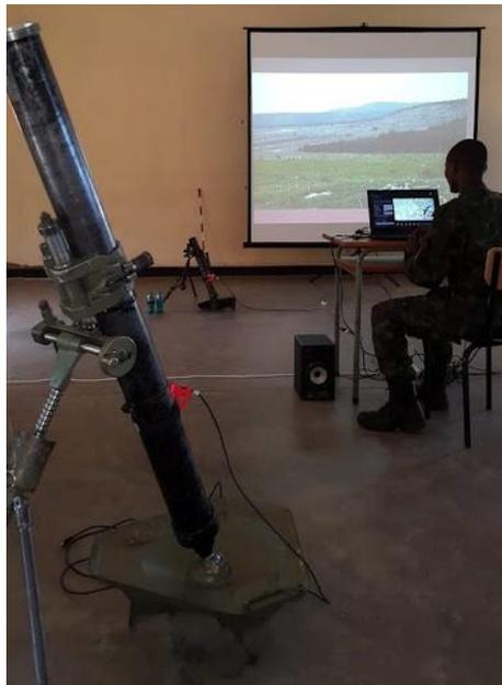
Nota. Fuente SMS Simulator. **Simulador de mortero de última generación**
