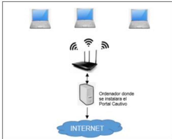
Fig. 1. Diagrama esquemático de conexión del Portal Cautivo
