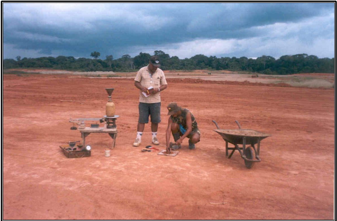
TOMA DE MUESTRAS EN LAS FRANJAS LATERALES DE LA PLATAFORMA
