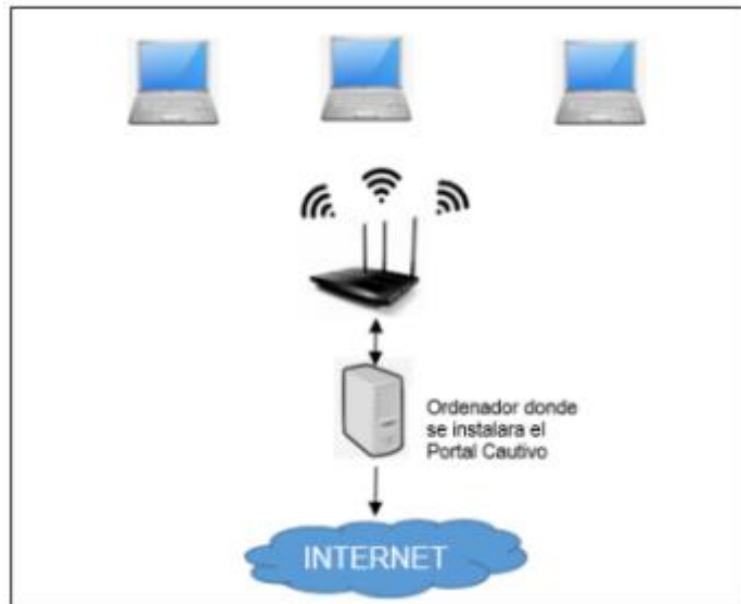
Fig. 1. Diagrama esquemático de conexión del Portal Cautivo
