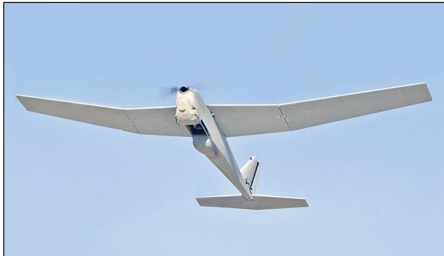
Figura 2 Vehículo aéreo no tripulado (UAVs) AeroVironment RQ-20 Puma
