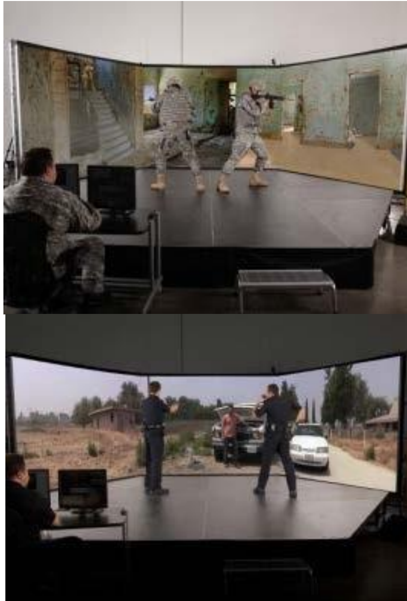
FIGURA 06 “Simulador de tiro VIRTRA V-180” (AASIAS, s.f.)
