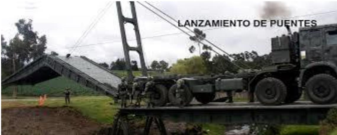
Figura 33 práctica del lanzamiento de puentes
