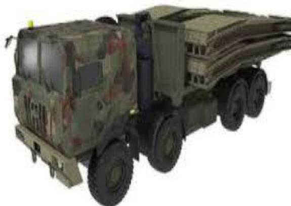
Figura 24 Carro lanza puentes
