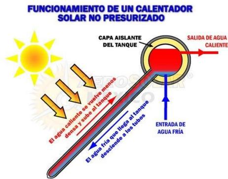
Figura N° 07. Funcionamiento de un calentador solar
