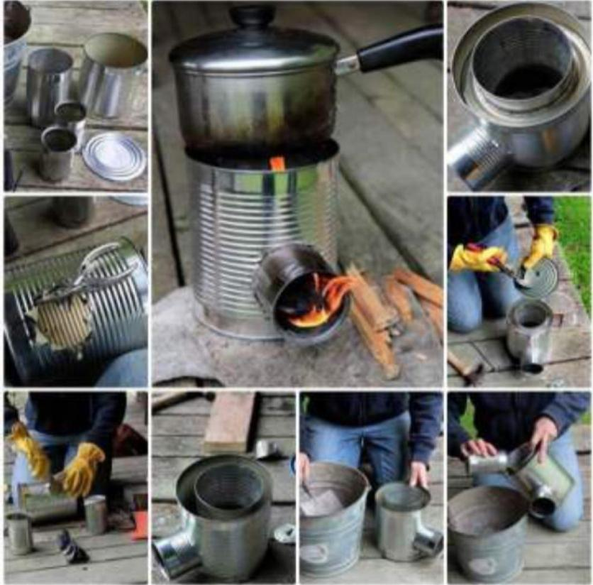
Foto N° 8: Construcción de cocina Rocket con latas
