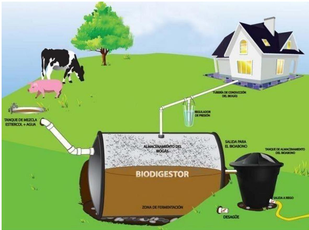
Figura N° 11. Proceso circular del biodigestor.
