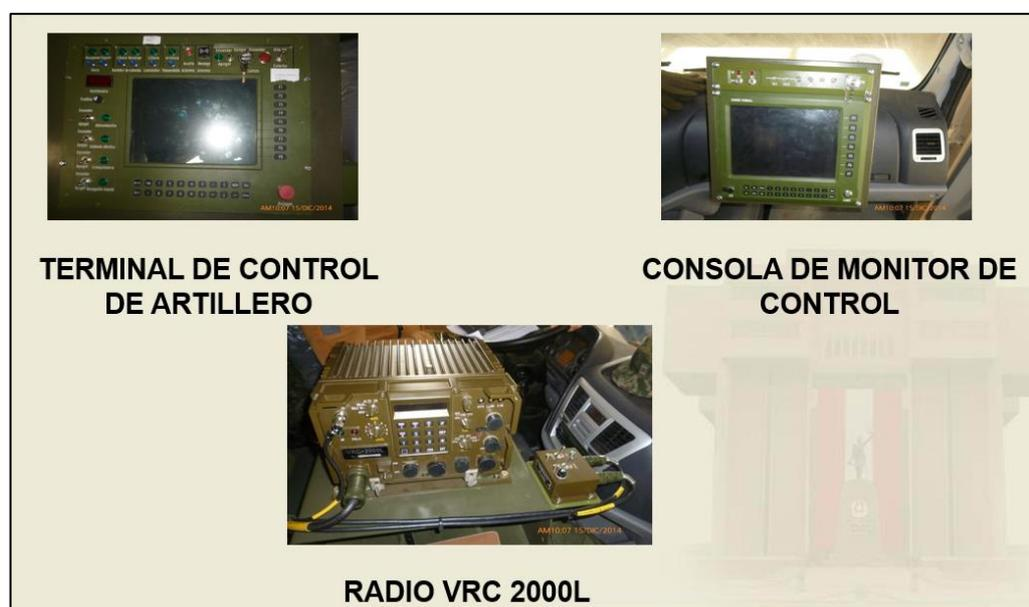
Figura 3: Equipo de comunicaciones en el LM 90 B
