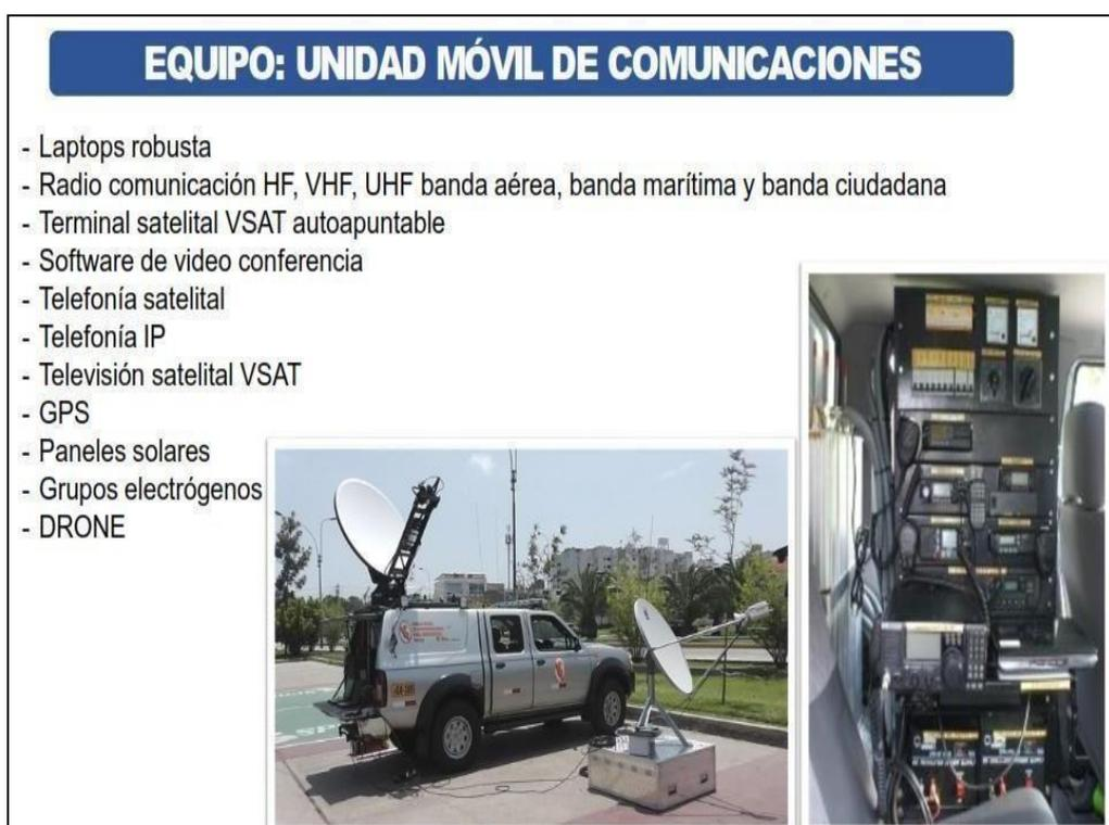
Figura 18. Unidad Móvil de Comunicaciones en apoyo a los centros de operaciones de emergencia (COE). Tomado de "Tecnologías aplicadas para realizar el monitoreo de las Emergencias". Recuperado de <http://unam.edu.pe/coresur2019/wp-content/uploads/2019/09/tecnologia.pdf>
